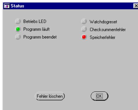
Es werden die beiden Statusregister des SRG-1 ausgelesen und der Status des Geräts angezeigt, evtl. aufgetretene Fehler können gelöscht werden.
